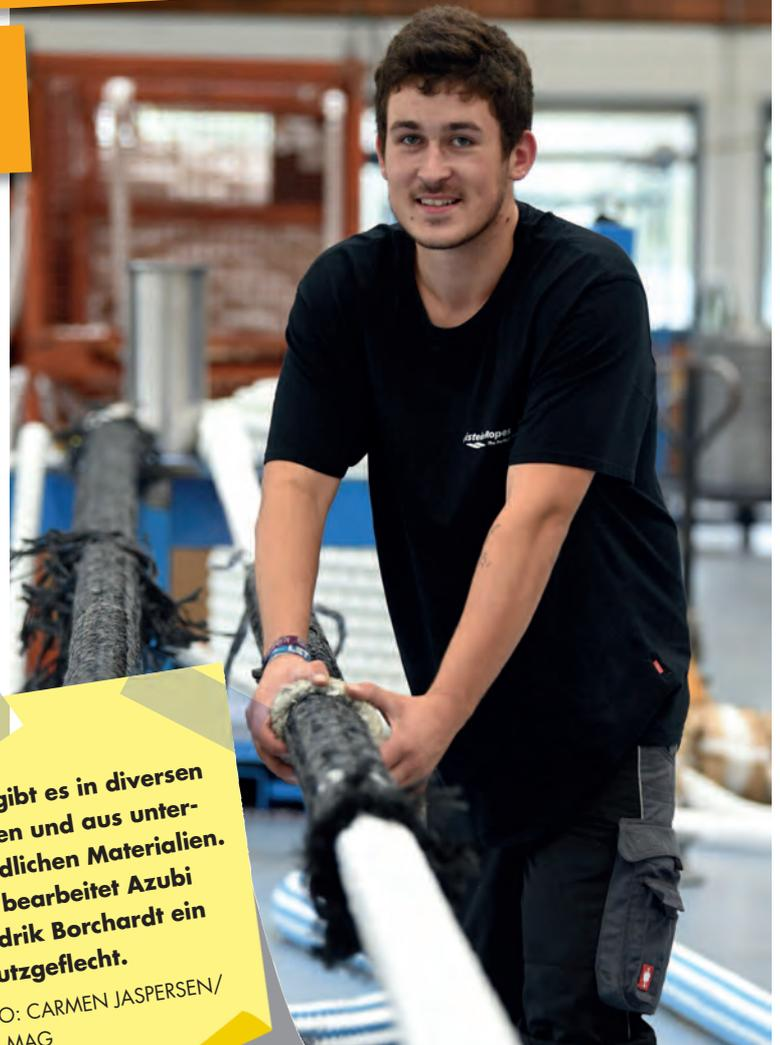
Maschinen - in der Verseil- und Seilschlagmaschine sowie in der Flechtmaschine. In letzterer werden die einzelnen Fäden zu einem Seil verflochten. «Dabei kommt es darauf an, die Garne an der richtigen Stelle in die Maschine einzufügen», so Borchardt. Sobald das Seil fertig ist, wird es auf Qualität und Belastbarkeit geprüft. Dann kommt es in die Konfektionierung, also in die Weiterverarbeitung.
